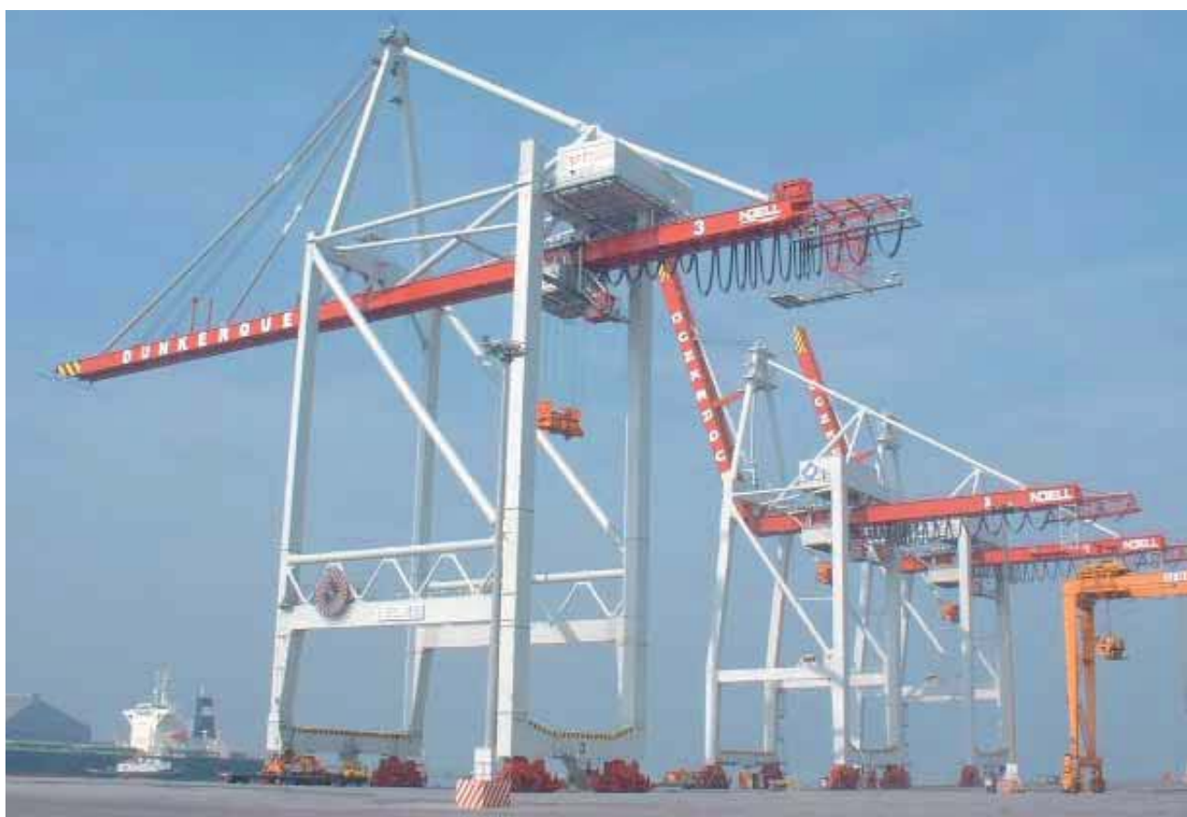
VAHLE-Motorleitungstrommeln und Leitungswagen an Containerkranen im Hafen Dünkirchen
