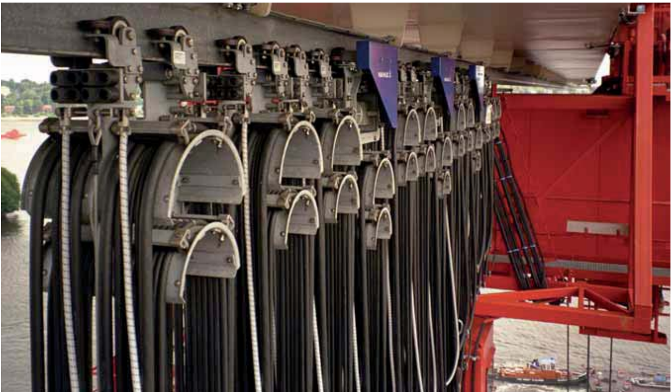
Angetriebene Leitungswagenanlage, 2-stöckig
